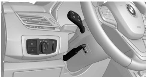
Das Lichtschalterelement befindet sich neben dem Lenkrad.
