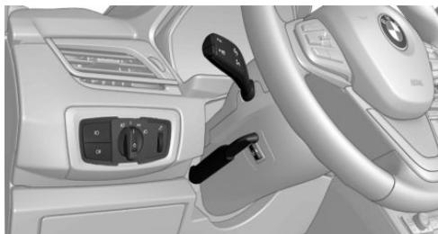
Comutatorul de lumini se află lângă volan.
